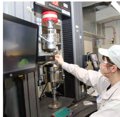
アルミ板強度をみる引張試験
