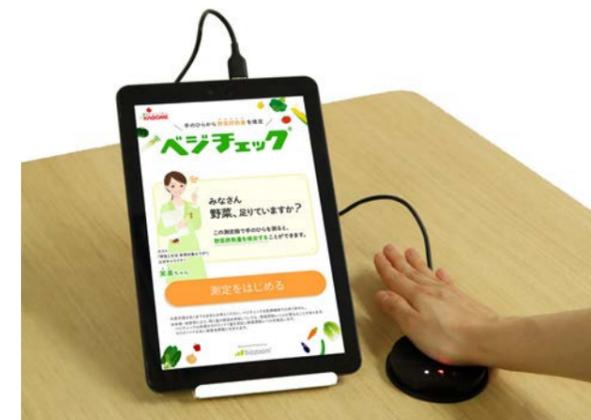
センサーに手のひらを押し当てて、約 30 秒で簡単に野菜摂取量を推定できる機器で、皮膚のカロテノイド量から野菜摂取量を推定しています。
