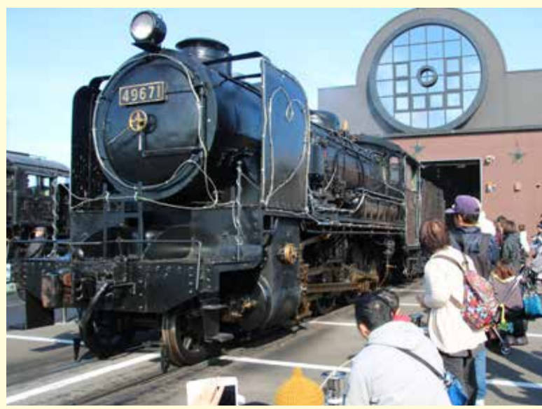
キューロクの圧縮空気による自走
