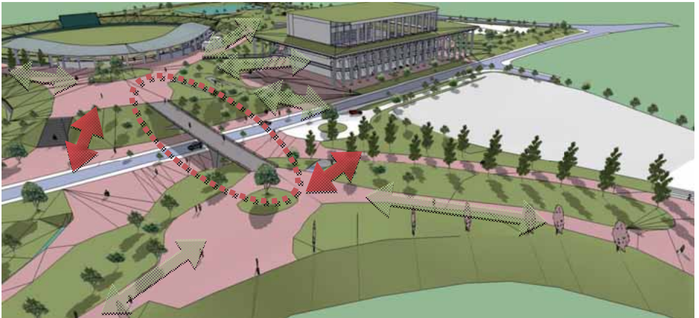
■スロープ（緑）と階段（赤）で多様な方向から動線が集約するペDESTリアンデッキの全体構成（南北を結ぶ象徴軸と東西に連なる主要施設）
